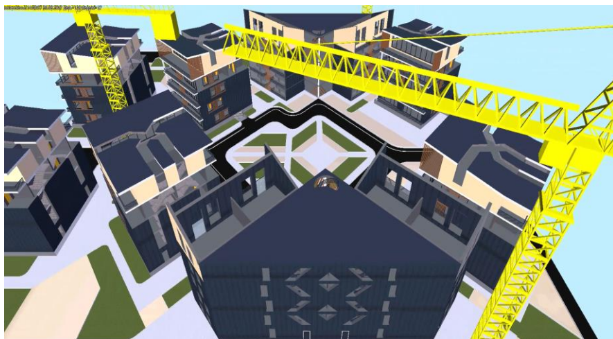
Визуализация календарного графика строительства
